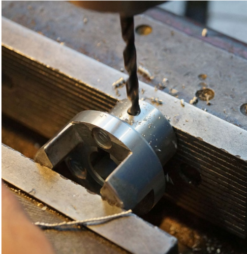
Abbildung 6: Bohren einer Kupplung (Quelle: Klebs+Hartmann GmbH & Co. KG)
