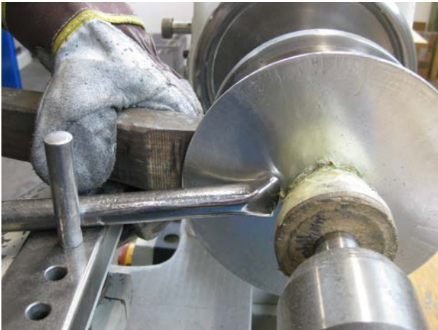
Abbildung 11: Fachrichtung Metalldrücktechnik – Aufziehen des Werkstückes mit Aufziehstahl und Druckspeitel
