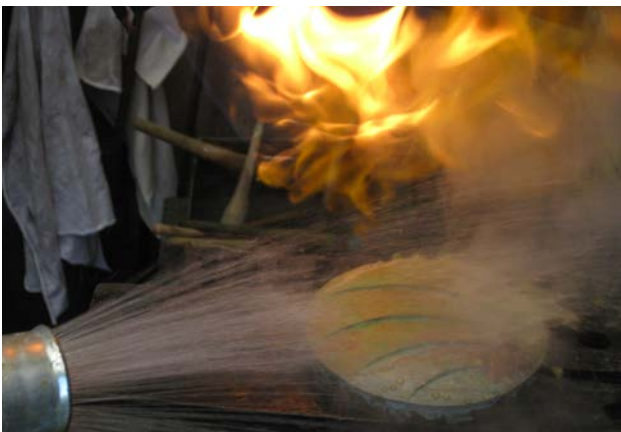
Abbildung 6: Fachrichtung Ziseliertechnik – Einbrennen einer Feuerpatina und Kühlung mit Wasser
