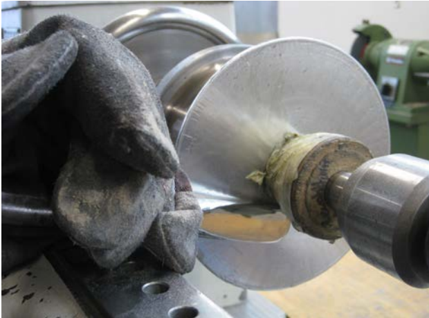
Abbildung 19: Fachrichtung Metalldrucktechnik – Drücken mit Langstahl
