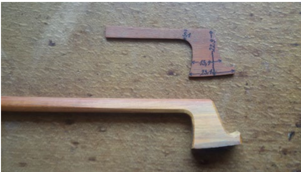
Abbildung 6: Ausgesägter Violinbogenkopf mit Schablone G. Spätling
