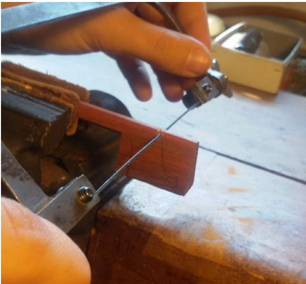
Abbildung 11: Aussägen eines Bogenkopfes nach Modell G. Spätling
