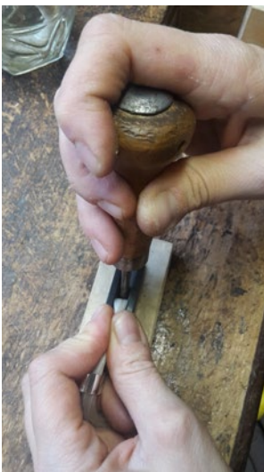
Abbildung 5: Bezug mit speziellem Stempel in den Frosch drücken G. Spätling
