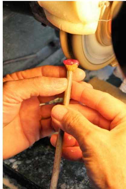
Abbildung 46: Feinschleifen – Cabochon © Jahke
