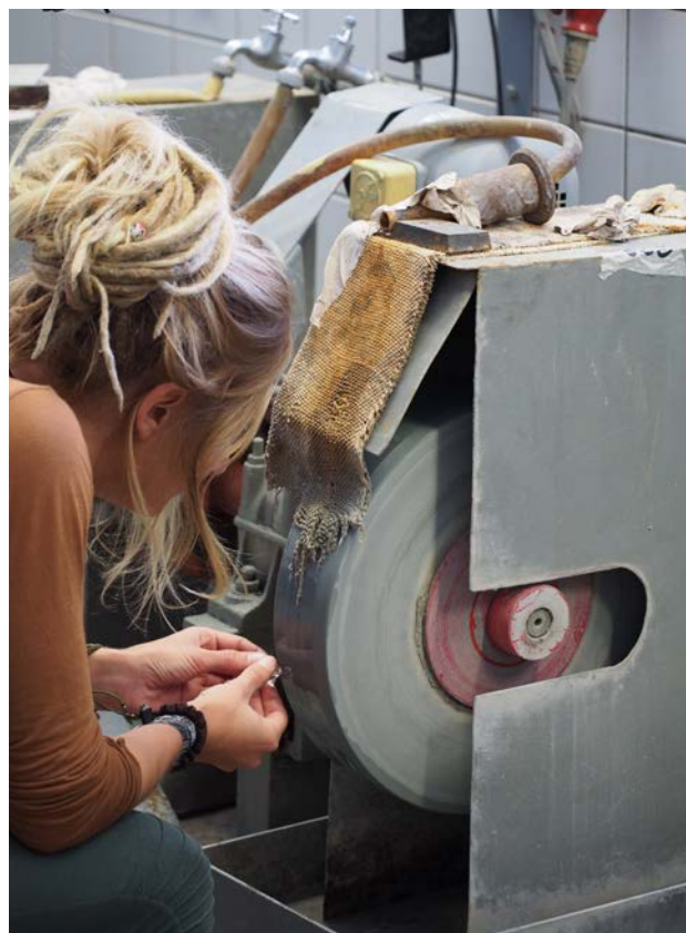
Abbildung 3: Azubi beim Edelsteinschleifen – Glattschliff © Schäfer
