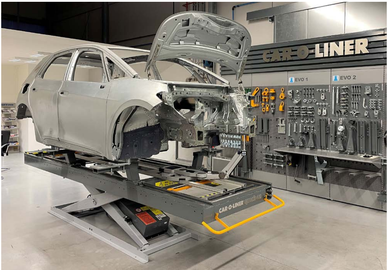
Abbildung 10: Rohkarosserie eines VW ID3 auf einem Karosserievermessungs- und Richtsystem der Firma Car-0-Liner (Quelle: R. Büttner, Car-0-Liner Deutschland GmbH)
