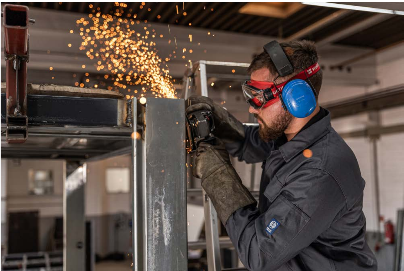
Abbildung 21: Verschleifen einer MAG-Schweißnaht an einem Nutzfahrzeug-Aufbau mit einen Einhandwinkelschleifer (Quelle: ZKF)
