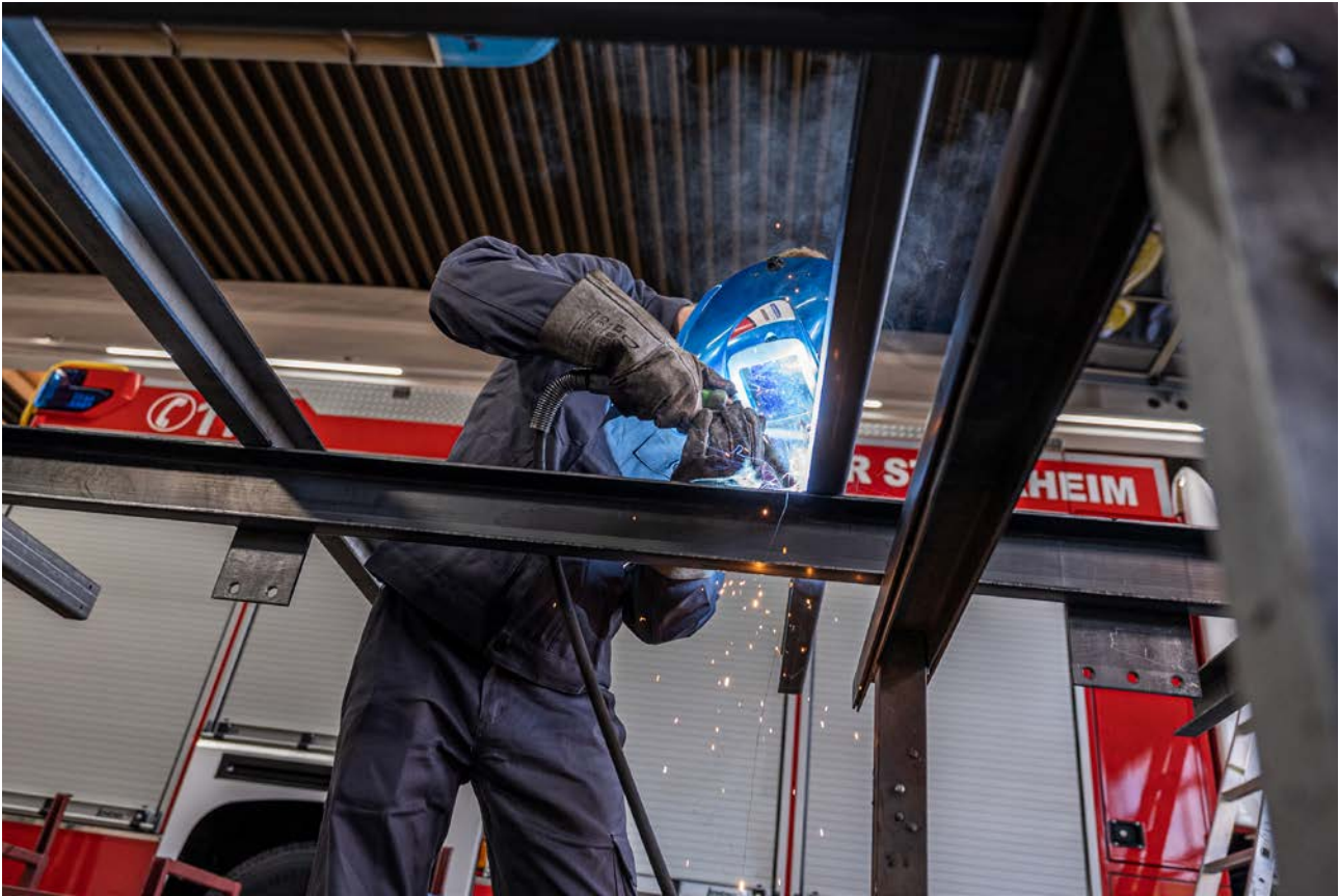
Abbildung 27: Fügen einer Rahmenkonstruktion mit dem MAG-Schweißverfahren (Quelle: ZKF)
