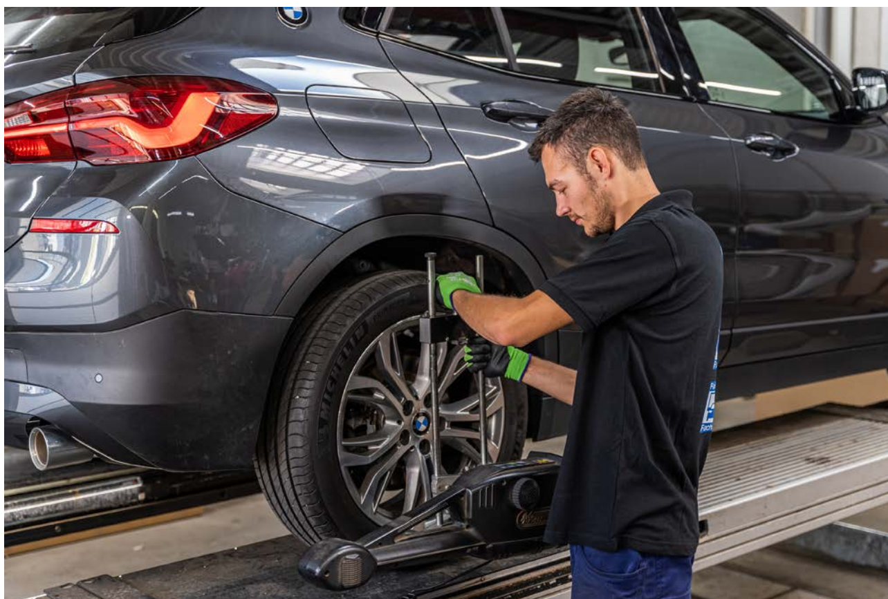
Abbildung 23: Vorbereitende Arbeiten zum Vermessen der Fahrwerksgeometrie (Quelle: ZKF)
