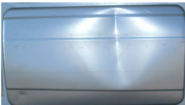
Abbildung 36: Beschädigte Tür des Kunden (Quelle: ZKF)
