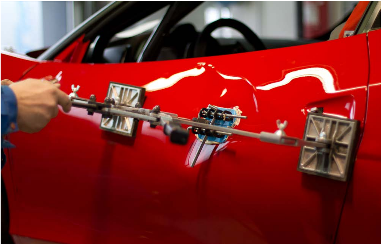
Abbildung 31: Instandsetzung einer Türaußenhaut mittels Flächenausbeul-System (Quelle: ZKF)
