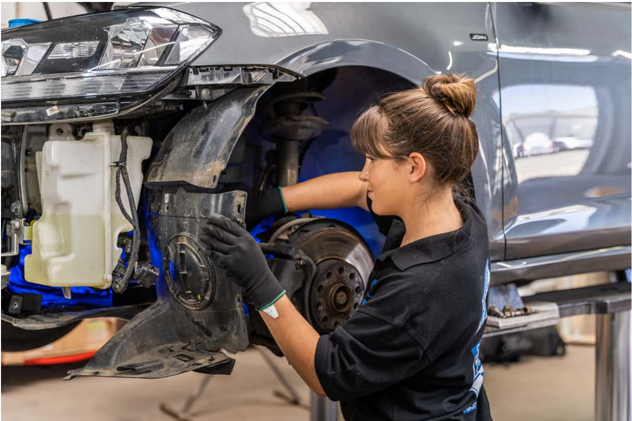
Abbildung 6: Eine Karosserie- und Fahrzeugbaumechanikerin in der Fachrichtung Instandhaltungstechnik demontiert eine defekte Radhausschale (Quelle: ZKF)
