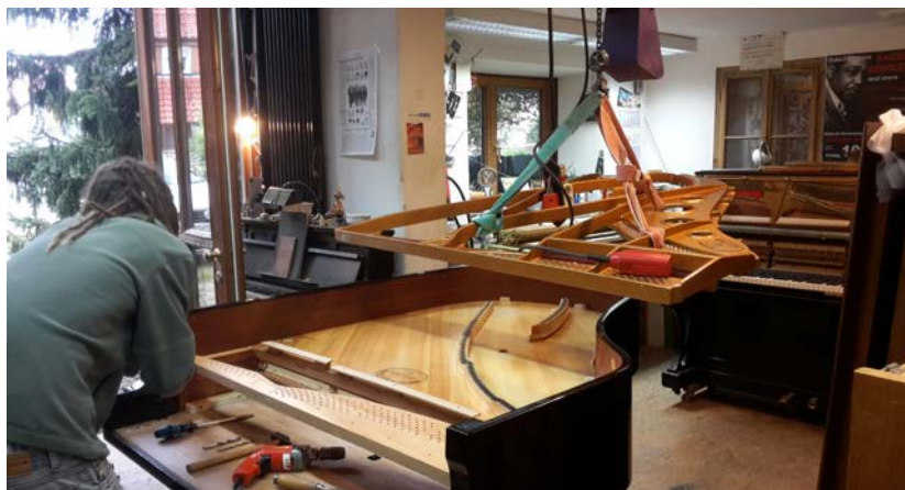
Abbildung 3: Einbau der Gussplatte (Gussrahmen) © Striegel
